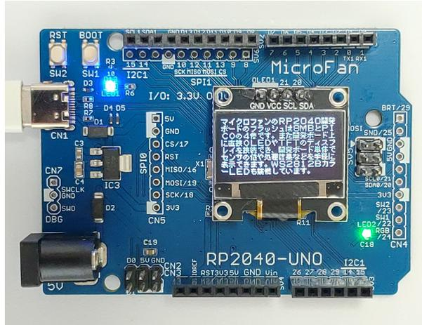
図 2.3 OLED ディスプレイを搭載した RP2040-UNO
