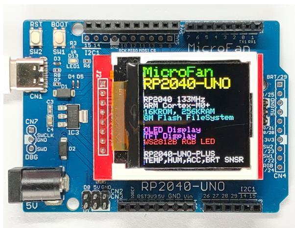
図 2.2 TFT ディスプレイを搭載した RP2040-UNO
