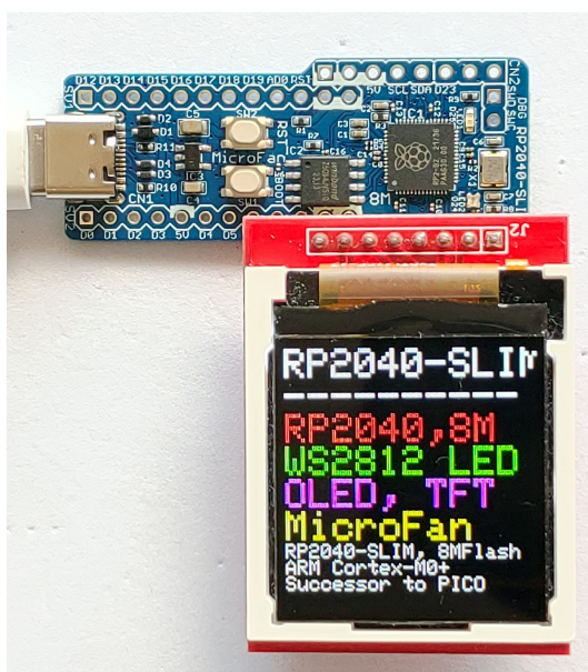
図 2.5 TFT ディスプレイを搭載した RP2040-SLIM
