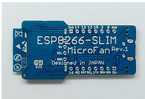
図 3.3 ESP8266-SLIM-R1 の裏面の SJ1
