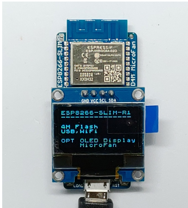
図 2.2 OLED ディスプレイを搭載した ESP8266-SLIM-R1
