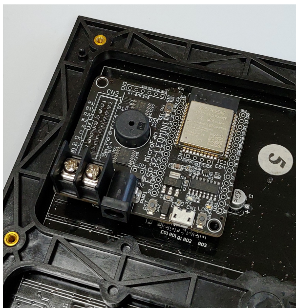
図 3.4 LED パネルと ESP32-LEDMINI の接続
