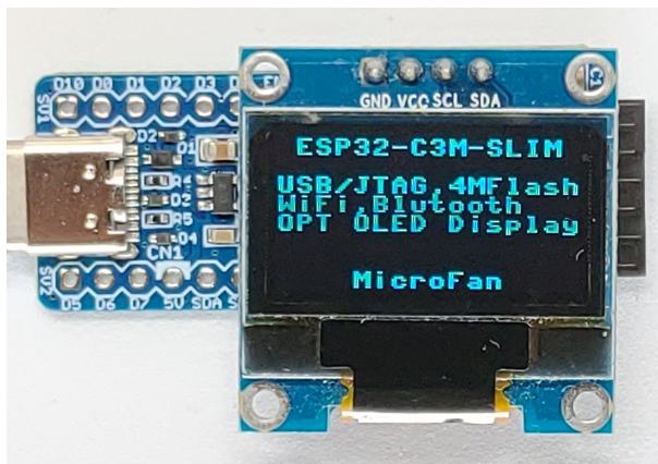
図 2.2 OLED ディスプレイを搭載した ESP32-C3M-SLIM-R1
