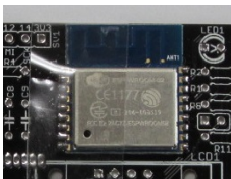
図 3.3 ESP-WROOM-02 の仮止めと仮はんだ付
