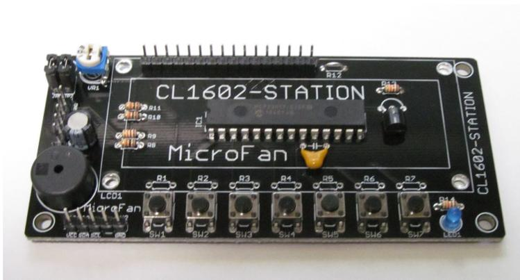
図 3.1 文字液晶ディスプレイ取り付け用のピンヘッダー
